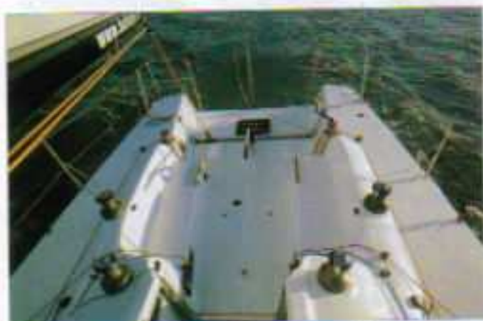
Barreur, équipiers, réglage de GV disposent de cales. Les winches les plus sur l'arrière servent à l'écoute de GV.
