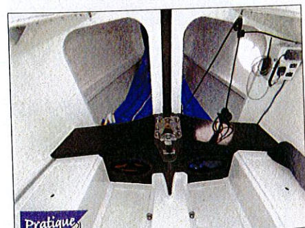
Un caisson en carbone participe au maintien du puits de quille.
