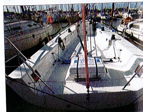
▲ Les winches Harken les plus en arrière servent au réglage de l'écoute de GV.
