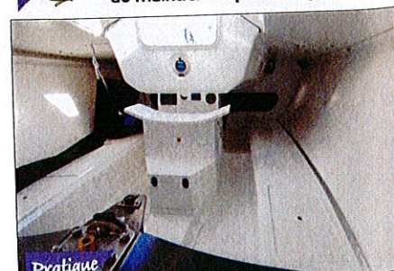
Le coffre de descente abrite le Volvo Penta de 20 chevaux.
