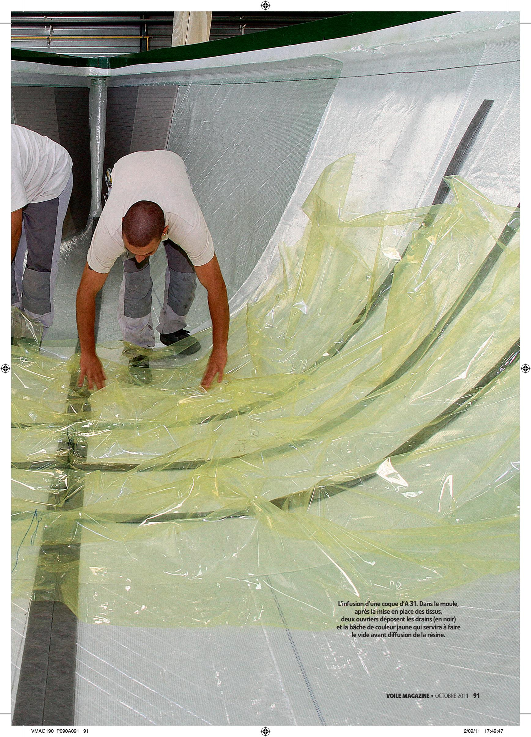
L'infusion d'une coque d'A 31. Dans le moule, après la mise en place des tissus, deux ouvriers déposent les drains (en noir) et la bâche de couleur jaune qui servira à faire le vide avant diffusion de la résine.
