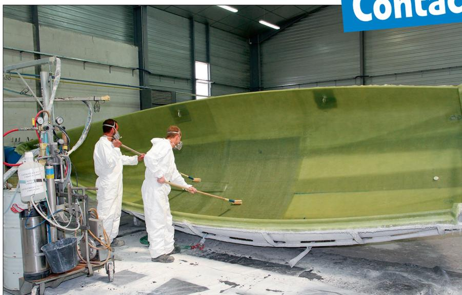
▲ Le moulage au contact d'une coque de Surprise. Au premier plan, la machine qui permet de projeter la résine polyester sur les tissus qui sont ensuite roulés et ébullés.
