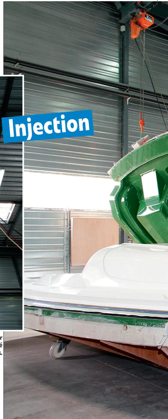
noms – injection Eco ou RTM (Résine Transfert Moulding) –, elle consiste à injecter de la résine entre deux moules rigides, mâle et femelle. Intérêt de la méthode, on obtient des pièces parfaitement lisses des deux côtés et on garde le contrôle des matières utilisées, verre et résine. Les opérations peuvent se répéter à l'infini avec un contrôle rigoureux du dimensionnement.
