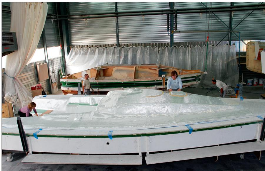
▲ Opération de drapage sur le moule d'un pont d'A 31. Après gel-coatage, on pose des tissus et des plaques de mousse puis on recouvre l'ensemble d'un second moule avant d'injecter la résine.
