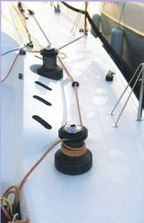
Una brazola de forma suave, pensada para desviar el agua, acoge los winches primarios que se usan para escotas de génova y brazas. Los remolques, las mordazas de barber y los reenvíos están bien colocados.
