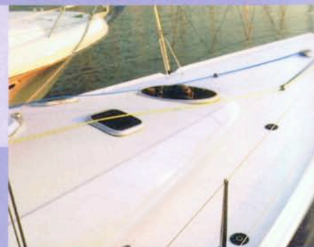
Un tambucho de entrada redondeada facilita el paso de velas. El piano central permite alternar winches en las maniobras complejas. Las mordazas escalonadas permiten regular sin bajar a sotavento.
