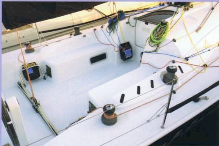
Entre los timones y la zona de bancos destaca el sector dedicado al trimmer de mayor, que dispone de barra de escota, winche a la alemana y comando de baquestay con botón de largado rápido.
