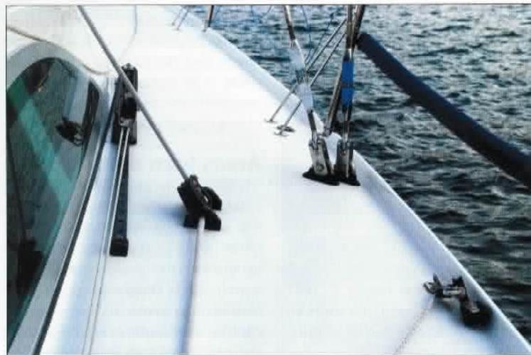
*El reenvío de la escota de mayor y el arraigo de obenques entorpecen ligeramente el paso por cubierta.*
